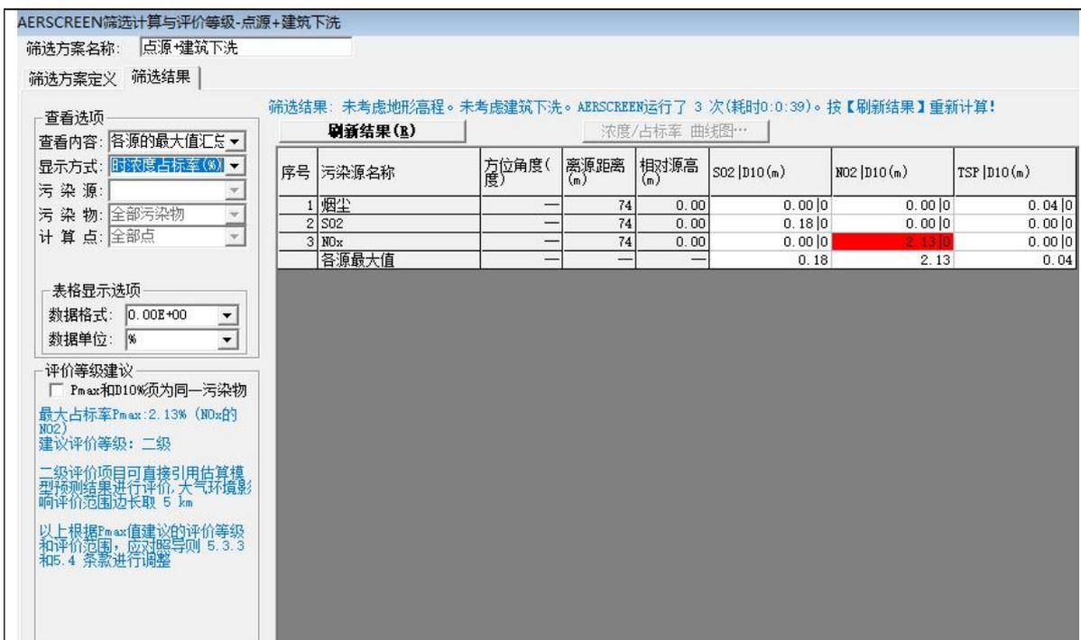
图 7-2 燃烧废气（2#排气筒）估算模式预测 二氧化硫、氮氧化物、烟尘最大落地浓度占标率
