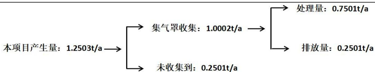
图 7-1 本项目有机废气平衡图
