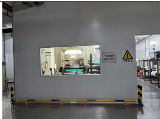
复合机（车间密闭微负压抽风收集）
