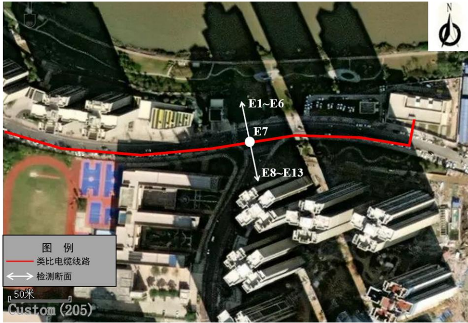
图 71 110kV 双回电缆类比电缆线路断面工频电场、工频磁场监测布点示意图
