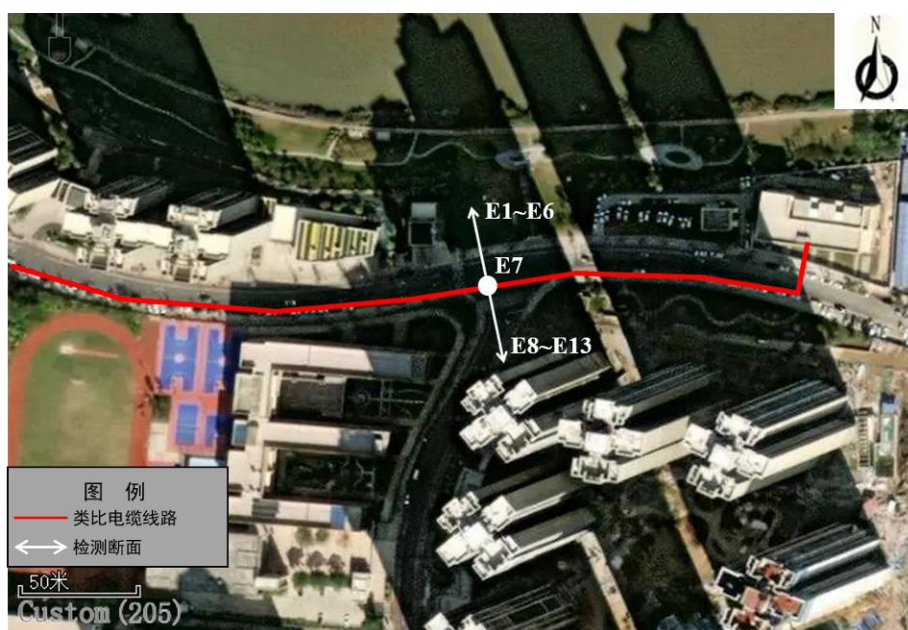
图 72 110kV 四回电缆类比电缆线路断面工频电场、工频磁场监测布点示意图
