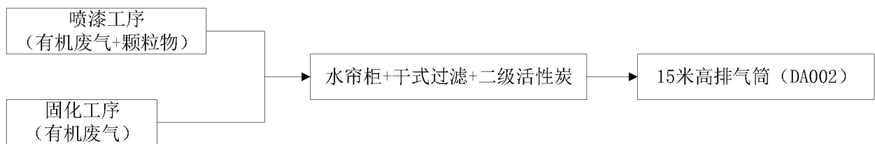
图 4-1 废气处理流程示意图
