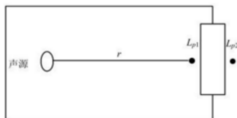
图 4-2 室内声源等效为室外声源图例
