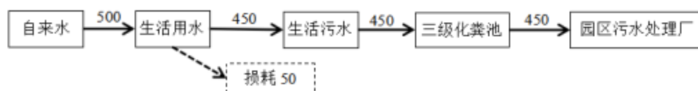
图 2 项目水平衡图 (单位: \text{m}^3/\text{a} )
