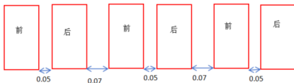
图 1 洗发水瓶包装卷膜印刷示意图
